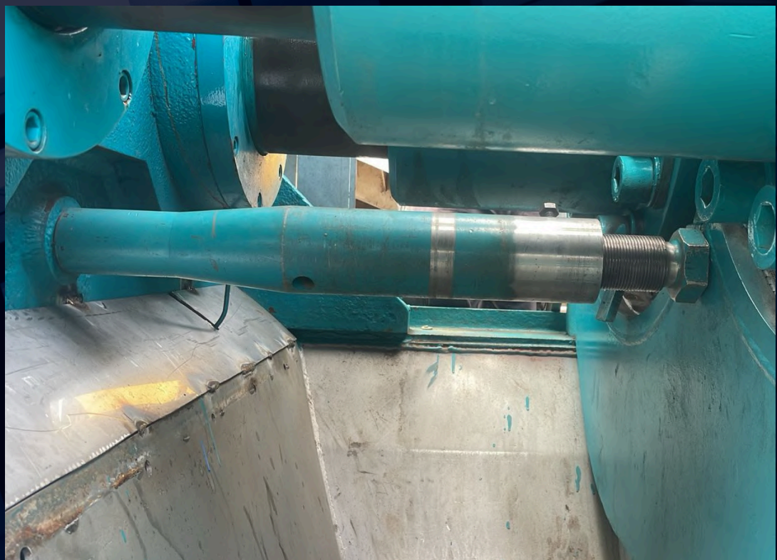
MECANIZADO DE TEMPLADOR PARA PRENSA EN VCN
