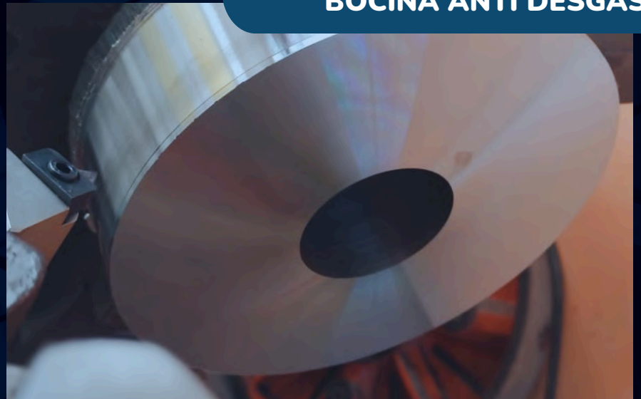
FABRICACIÓN DE RUEDAS CON BOCINA ANTI DESGASTE
